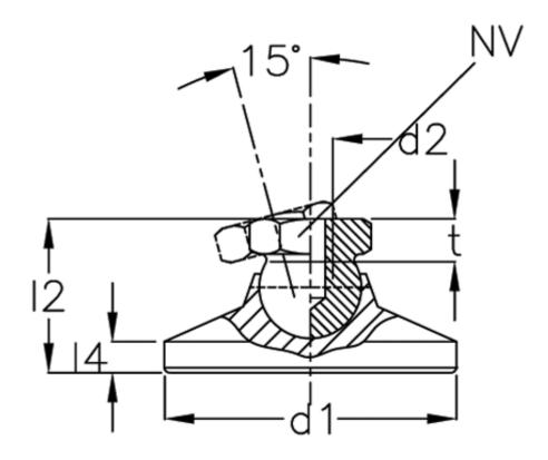
d1 = 50 d2 = 10 l2 = l4 = -NV = 15 Static load (kN) = 23 t min = 10.5
